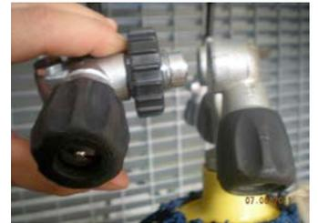
**4°.** Conectar línea de aire a la botella enroscando la conexión de carga en su grifo o válvula.
