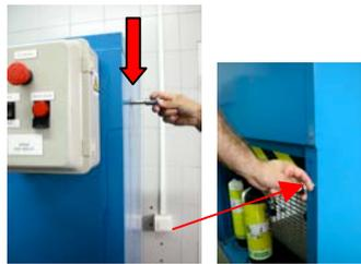
**14°.** Retiramos el pasador de seguridad y lo colocamos bloqueando la puerta, se desconectará la alarma de seguridad.
