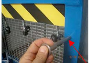
**2°.** Una vez abierta la compuerta, colocar el pasador de seguridad en el alojamiento frontal y el avisador acústico se desconectará automáticamente, pasando a condición segura.
